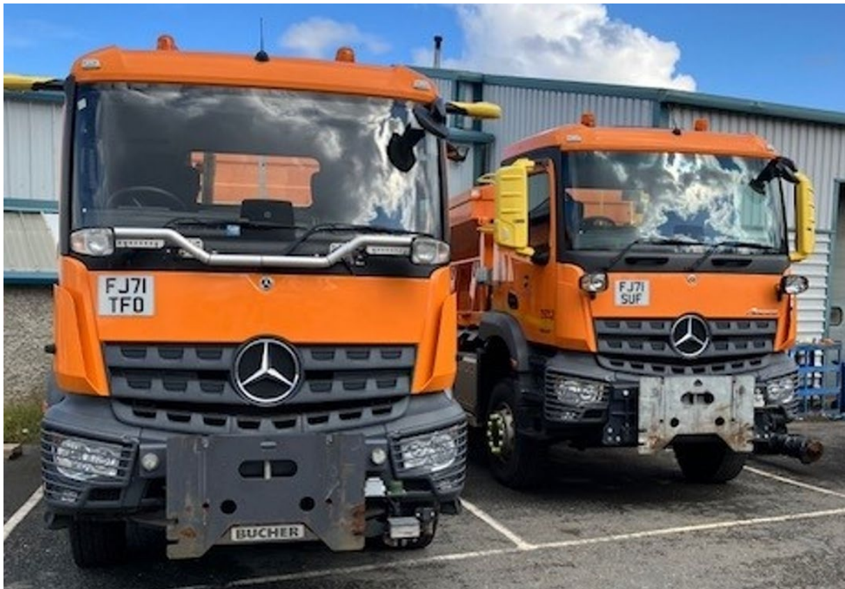
Ffigur 16 – Ar y chwith mae Mercedes 6x4 gyda chorff graeanu Bucher. Ar y dde mae Mercedes 4x4 wedi'i ffitio â graeanwr ffordd Bucher Electra, wedi'i bweru gan fatri lithiwm. Mae'n disodli hydrolig traddodiadol gyda phecynnau batri effeithlonrwydd uchel, gan ddarparu sero allyriadau, llai o wastraff halen, a hyd at 20 awr o weithredu fesul gwefr.
