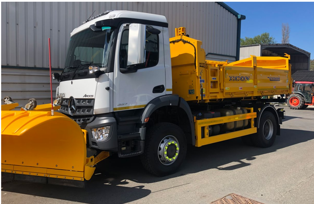
Ffigur 15 – Mercedes 4x4 wedi'i ffitio ag Econ Unibody, cerbyd cynnal a chadw ffyrdd a gwasanaeth gaeaf amlbwrpas arbenigol 6m 3 , 18 tonnelli. Mae'n cyfuno lorïau graeanu, dad-rewi, a lorïau tipio wedi'u hinswleiddio i mewn i un siasi i ymdrin â thasgau trwy gydol y flwyddyn fel halenu a thrwsio ffyrdd.
